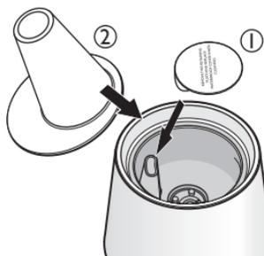
Entfernen Sie den wasserdichten Reinigungsverschluss und bringen Sie die Halterungsplatte und die Glasabdeckung wieder an.
