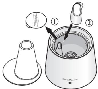
Entfernen Sie die Glasabdeckung. Tauschen Sie dann die Halterungsplatte gegen den wasserdichten Reinigungsverschluss aus, so dass die Belüftung komplett verschlossen ist.
