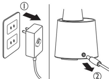
Trennen Sie das Netzteil von der Steckdose und anschließend vom Gerät.
