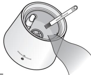
Entfernen Sie das Wasser aus dem Wassertank, geben Sie eine ausreichende Menge warmen Wassers ( max.40°C ) ( 103.9°F ) sowie einige Tropfen eines neutralen Reinigers hinzu. Reinigen Sie mit der mitgelieferten Reinigungsbürste vorsichtig die Innenseite des Tanks. Verwenden Sie zur Reinigung des Gerätes ausschließlich sauberes Wasser.
