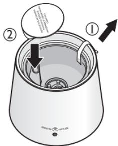
Entfernen Sie das Wasserstandetikett und befestigen Sie die Halterungsplatte über der Belüftung im Tank.
