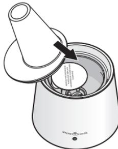
Stellen Sie sicher, dass die Halterungsplatte richtig befestigt ist und bringen Sie die Glasabdeckung an. Reinigen Sie, falls notwendig, mit einem sauberen Tuch die Oberfläche des Scentlizers.
