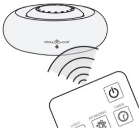
Richten Sie die Fernbedienung auf den Empfänger am Hauptgerät, drücken Sie zum Start des Gerätes die Ein-/Austaste.
