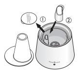
Retirez le cache en verre, sortez la plaque de maintien et placez le capuchon étanche sur l'orifice de ventilation.
