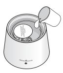
Versez lentement de l'eau dans le réservoir en veillant à ne pas dépasser la marque du niveau maximum, évitez de verser l'eau à proximité de l'échappement.
