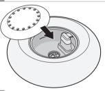
Assurez-vous que le chapeau d'échappement est correctement installé; posez ensuite le cache en verre et utilisez un chiffon propre pour nettoyer la surface de l'appareil et les surfaces alentours.
