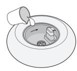
Versez lentement de l'eau dans le réservoir en veillant à ne pas dépasser la marque du niveau maximum, évitez de verser l'eau à proximité de l'échappement.
