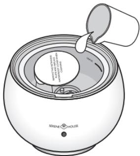
Versez lentement de l'eau dans le réservoir en veillant à ne pas dépasser la marque du niveau maximum, évitez de verser l'eau à proximité de l'échappement.
