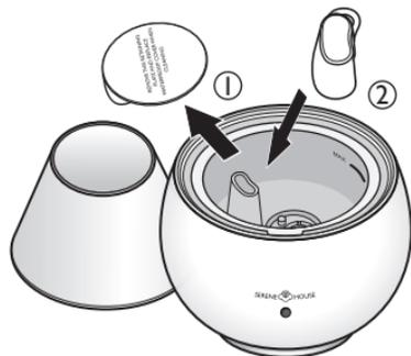
Retirez le cache en verre, sortez la plaque de maintien et placez le capuchon étanche sur l'orifice de ventilation.
