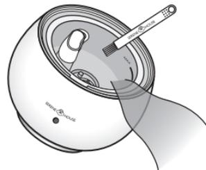
Videz l'eau du réservoir, ajoutez une quantité adéquate d'eau chaude ( ne dépassez jamais les 40°C ) ( 103.9°F ), ajoutez quelques gouttes de nettoyant neutre et utilisez la brosse fournie pour nettoyer délicatement l'intérieur du réservoir. Utilisez de l'eau fraîche pour un nettoyage intégral de l'appareil.
