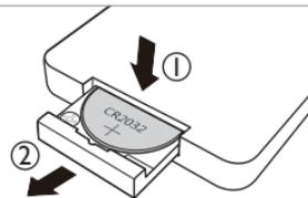
Pile au lithium CR2032 : côté positif tourné vers le haut au moment de l'insertion.
