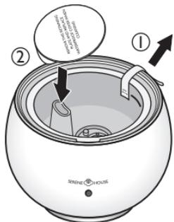
Retirez l'étiquette d'indication de niveau d'eau et insérez la plaque de maintien circulaire dans le dispositif d'échappement à l'intérieur du réservoir
