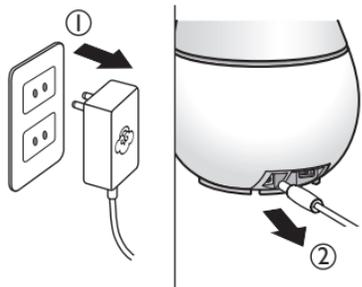
Débranchez l'adaptateur secteur de l'appareil et le câble branché à la base du diffuseur.
