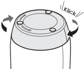
Befestigen Sie den Bodenabdeckung wieder am Hauptgerät, in dem Sie diese im Uhrzeigersinn festschrauben. Vergewissern Sie sich, dass diese fest am Gerät angebracht ist. Sie spüren ein Einrasten, wenn sie wieder festsitzt.
