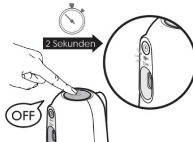
Halten Sie den Hauptschalter bei eingeschaltetem Gerät **länger als 2 Sekunden** gedrückt, bis das rote Licht leuchtet und sich das Gerät ausschaltet.
