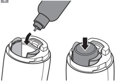
Setzen Sie die Sprühflaschen in den vorgesehenen Behälter. Drücken Sie die Flasche am Flaschenkörper mit Hilfe des Flaschenschutzes ganz in das Hauptgerät hinein.
