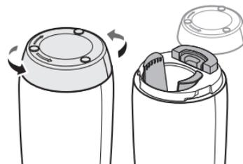
Nehmen Sie das Gerät in die Hand und drehen Sie es auf den Kopf, sodass der Boden nach oben weist. Nehmen Sie die Bodenabdeckung ab, indem Sie diese gegen den Uhrzeigersinn drehen. Sie sehen jetzt den Behälter für die Sprühflasche, den Flaschenschutz und den Batterie-Behälter.
