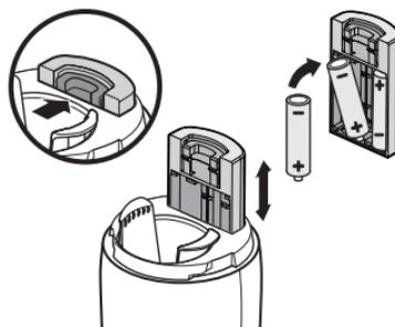
Lösen Sie den Batterie-Verschluss und nehmen Sie den Batterie-Behälter heraus. Installieren Sie drei neue AA-Alkalibatterien und setzen Sie den Batterie-Behälter wieder in das Gerät.
