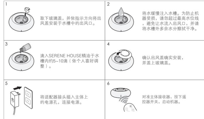
请使用自来水、软水或矿泉水，不建议使用其他液体，并请注意不要使用蒸馏水，因水中矿物质已被过滤，将影响机器雾化效果，不易产生雾气。
