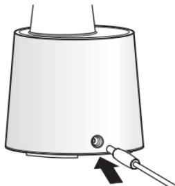
將變壓器的商品插頭安裝到主體的電源孔。
