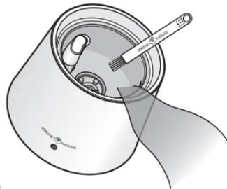
倒掉水槽中的水，加入適量溫水（勿超過水溫40°C），滴入少許中性清潔劑，使用內附清潔刷，輕輕刷洗水槽內部，再用乾淨的水將機器完全清洗乾淨。
