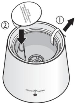
撕掉水位線標籤，再將圓形擋水板插入水槽內的出風口。
